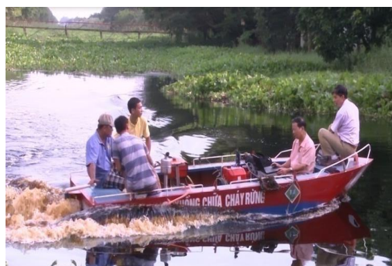
Hình 6. Thí nghiệm đo góc nghiêng ngang của xuồng chữa cháy
