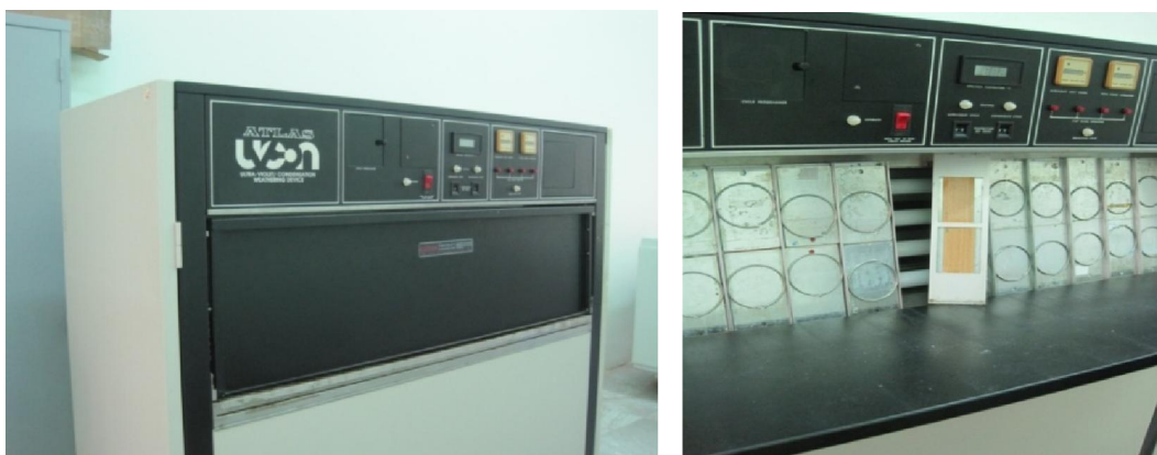
Hình 1. Thiết bị thử nghiệm thời tiết gia tốc Ultra-violet/condensation weathering device
