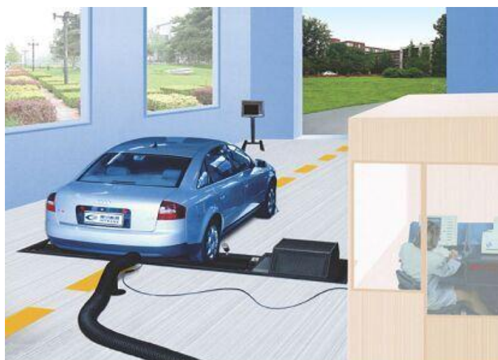
Hình 2. Mô phỏng hệ thống điều khiển và kiểm định khí thải xe ô tô theo phương pháp ASM
