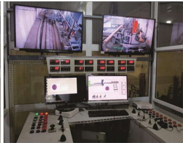
Dây chuyền xẻ gỗ tự động - Đề tài cấp Nhà nước
