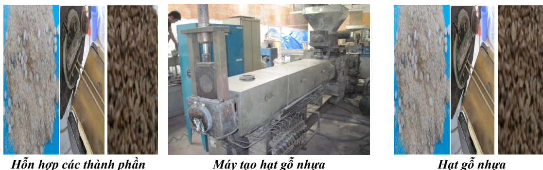
Hình 01. Quá trình tạo hạt gỗ nhựa
