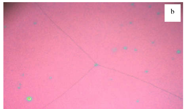
Hình 3a,b. Ảnh quang học của màng PZT trên điện cực Pt sử dụng quy trình ủ nhiệt 1, P(60) 6 lớp (a), PZT(40) 6 lớp (b)
