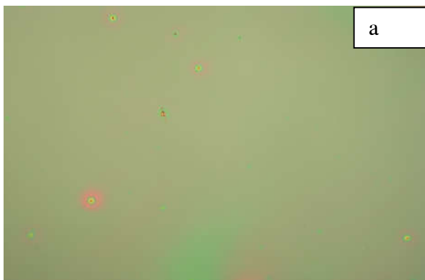
Hình 4a,b. Ảnh quang học của màng PZT trên điện cực Pt sử dụng quy trình ủ nhiệt 2, P(60) 6 lớp (a), PZT(40) 6 lớp (b)
