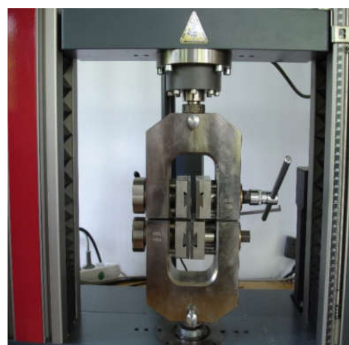
Hình 2. Máy kiểm tra cường độ kéo dọc thớ của ván mỏng universal ZWICK Z 010
